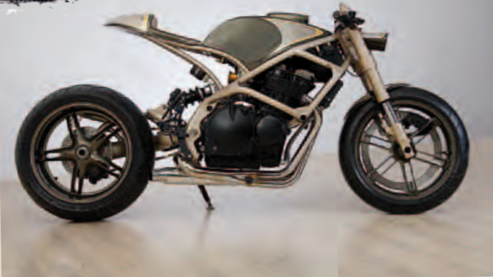
Wilbers-Federbein nebst Mikuni TMR. Eingerahmt von Eigenbau-Heckrahmen und -Cantilever.
