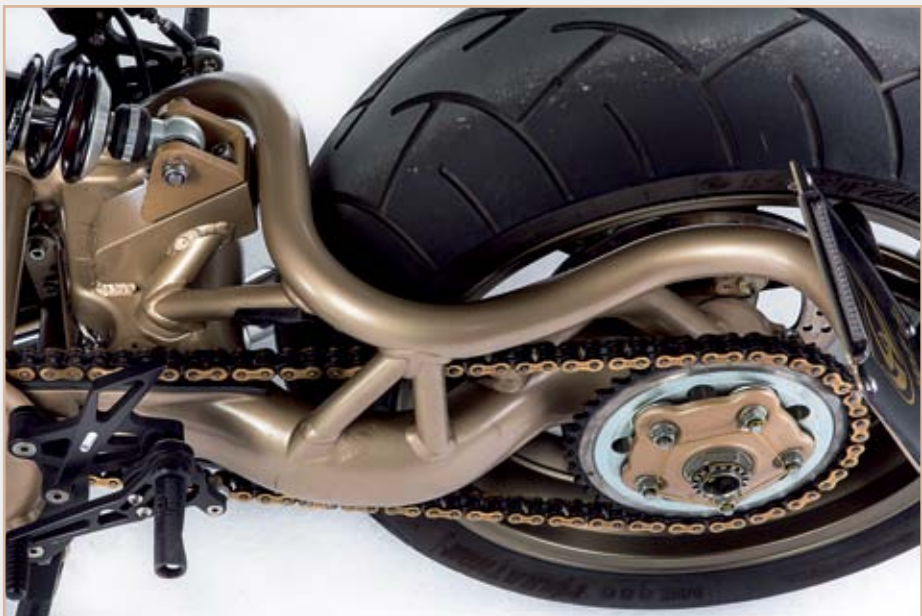
Die Ducati-Schwinge fügt sich harmonisch in das Moto-Martin-Fahrwerk ein
